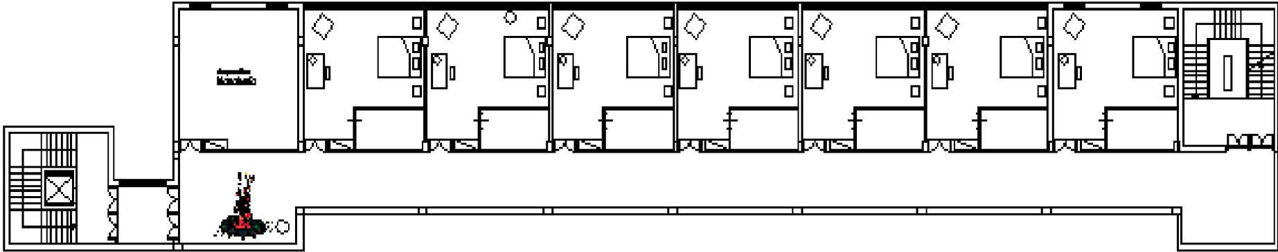
*Incendio che si sviluppa con la combustione di un materiale con curva di crescita ultra veloce, ubicato nella via di esodo più importante. Le porte interne all'inizio dell'incendio sono aperte. Nel caso in esame la pavimentazione è in moquette, le pareti rivestite e l'incendio inizia da un cestino pieno di carta.*
