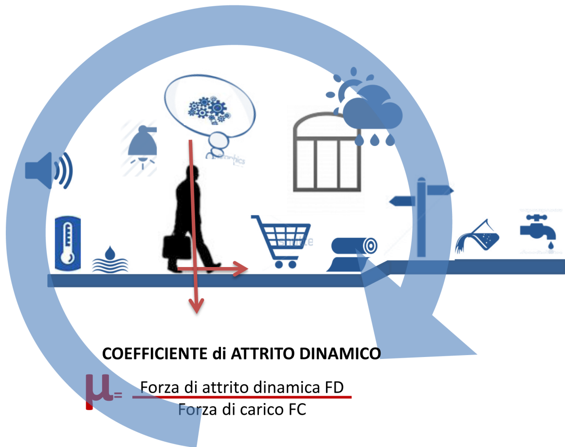
Fig.6 Fattori che incidono sul coefficiente di attrito dinamico.
