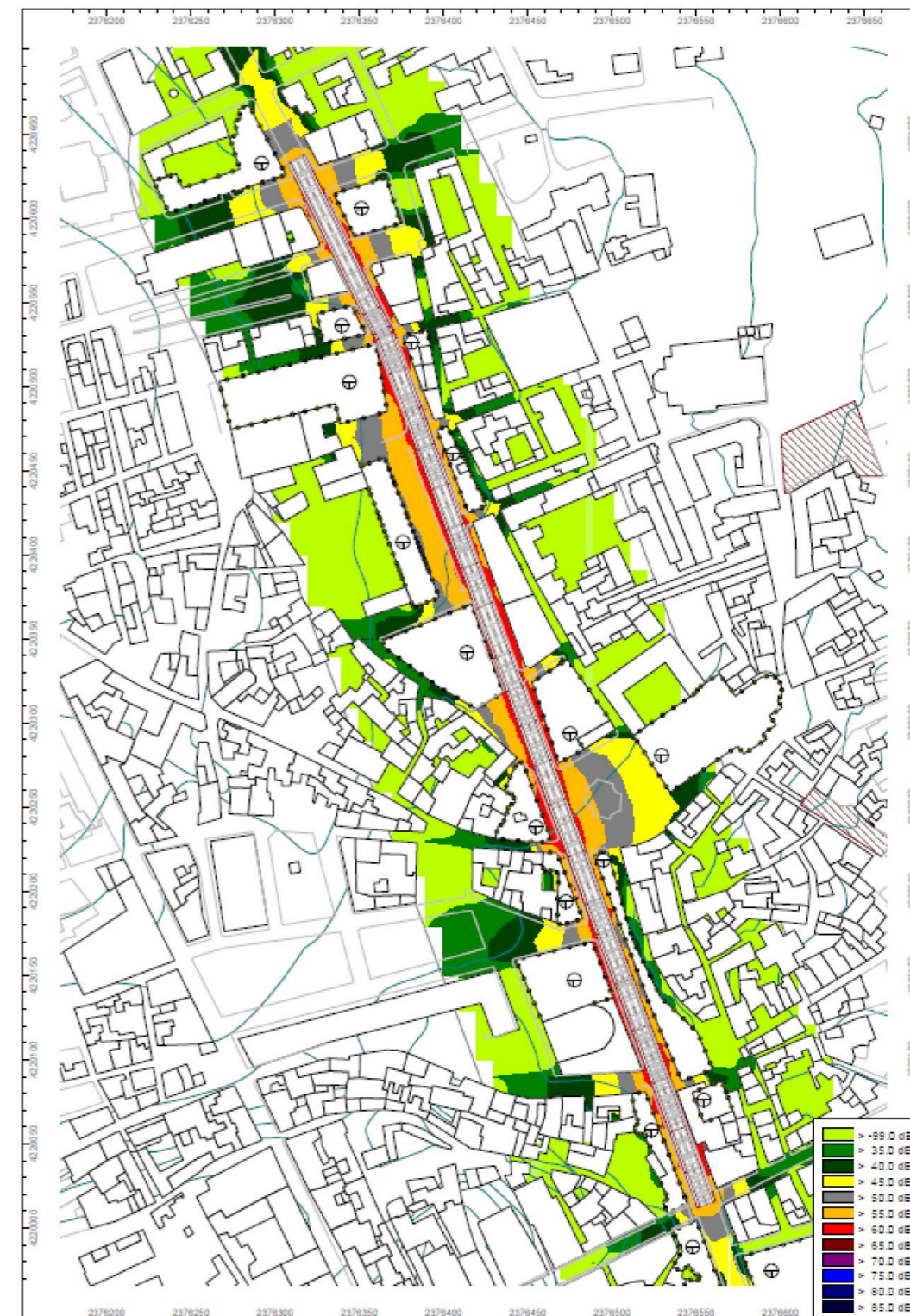
Componente rumore in fase di esercizio – Via Roma – Distribuzione isofoniche h=4 m
