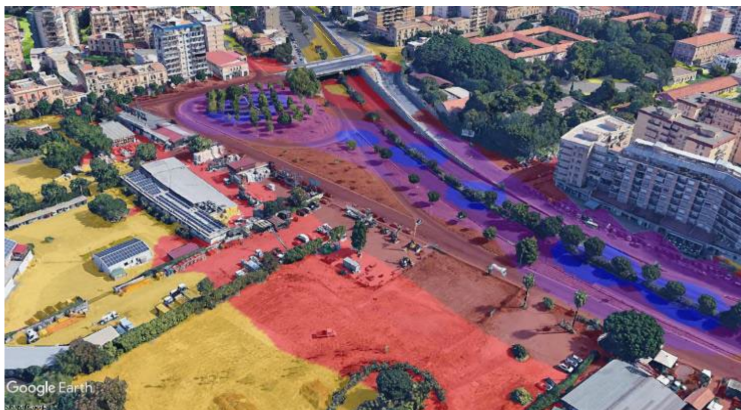
Componente rumore in fase di cantiere – Cantiere operativo Calatafimi – Distribuzione isofoniche
