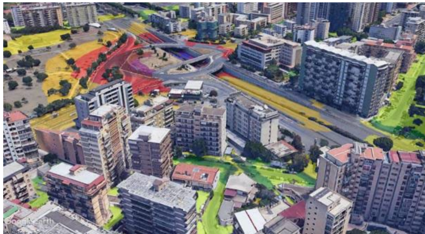
Componente rumore in fase di cantiere – Cantiere operativo Einstein – Distribuzione isofoniche
