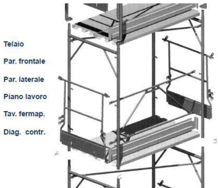
**Fig. 10 - Accessori principali di un ponteggio prefabbricato (modulo base) tipo Tel Dal della Ponteggi Dalmine S.p.A**
